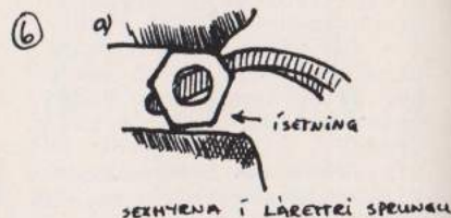
HNETA MEÐ ÁTAKSLÍNU UPP, STYRIR LÍNUNNI UPP TRYGGINGAKERFIÐ TIL AÐ KOMA Í VEG FYRIR AÐ HNETUR LUSNI.
