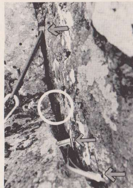
Nr. 4. Í hringnum er bongfleygur vitlaust rekinn í, gagnslaus. Örvarnar benda á hnetur. Fleygurinn fannst fastur þarna.
